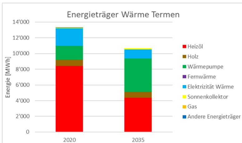
Abbildung 15: Energieträgeraufteilung Wärme Termen 2020 und 2035
