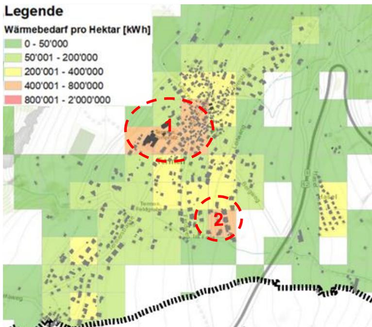
Abbildung 3: Wärmedichte im Hektarraster. Rot eingekreist sind Gebiete, für die eine Fernwärmeversorgung interessant sein könnte.
