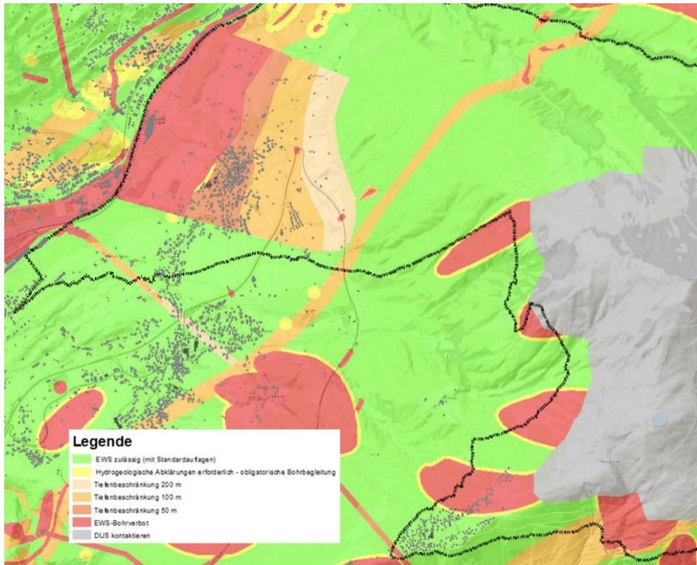
Abbildung 9: Zulässigkeitskarte für Erdwärmesondennutzungen im dichtbesiedelten Bereich von Termen.
