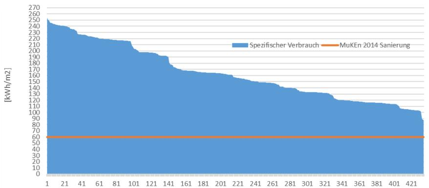
Abbildung 2: Spezifischer Wärmebedarf pro Gebäude in Termen in [kWh/m<sup>2</sup>a] (blau) sowie der theoretische Verbrauch der mit einer Sanierung nach Energiegesetz erreichbar ist (orange). Auch wenn die Verbrauchsdaten zu hoch geschätzt wurden, geben die Angaben auf der Grafik ein Indiz, dass das Potential im Gebäudepark sehr hoch ist.
