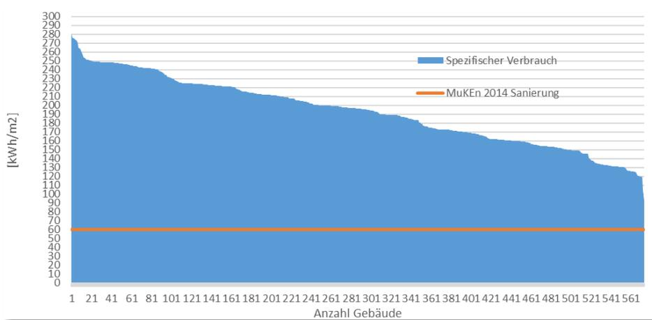
Abbildung 3: Spezifischer Wärmebedarf pro Gebäude der Riederalp in [kWh/m<sup>2</sup>a] (blau) sowie der theoretische Verbrauch der mit einer Sanierung nach Energiegesetz erreichbar ist (orange). Auch wenn die Verbrauchsdaten zu hoch geschätzt wurden, geben die Angaben auf der Grafik ein Indiz, dass das Potential im Gebäudepark sehr hoch ist.
