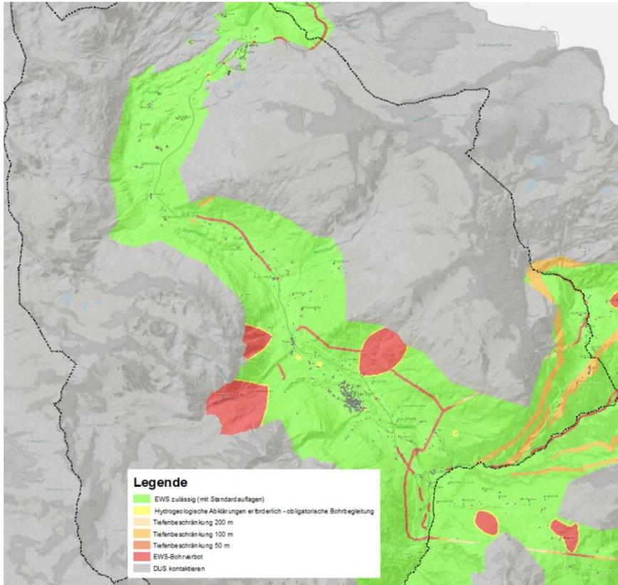
Abbildung 9: Zulässigkeitskarte für Erdwärmesonnennutzungen im dichtbesiedelten Bereich von Simplon.
