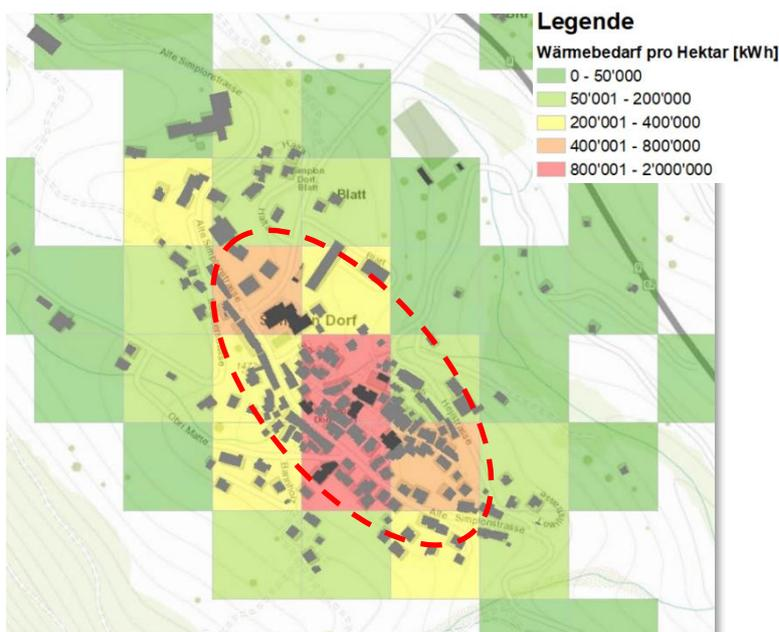
Abbildung 3: Wärmedichte im Hektarraster. Rot eingekreist ist das Gebiet, für welches eine Fernwärmeversorgung interessant ist.
