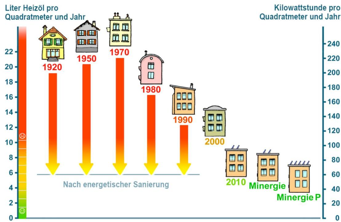
Abbildung 5: Typische Energiekennzahlen und Einsparpotentiale für den Wärmebedarf nach Gebäudebaujahr
